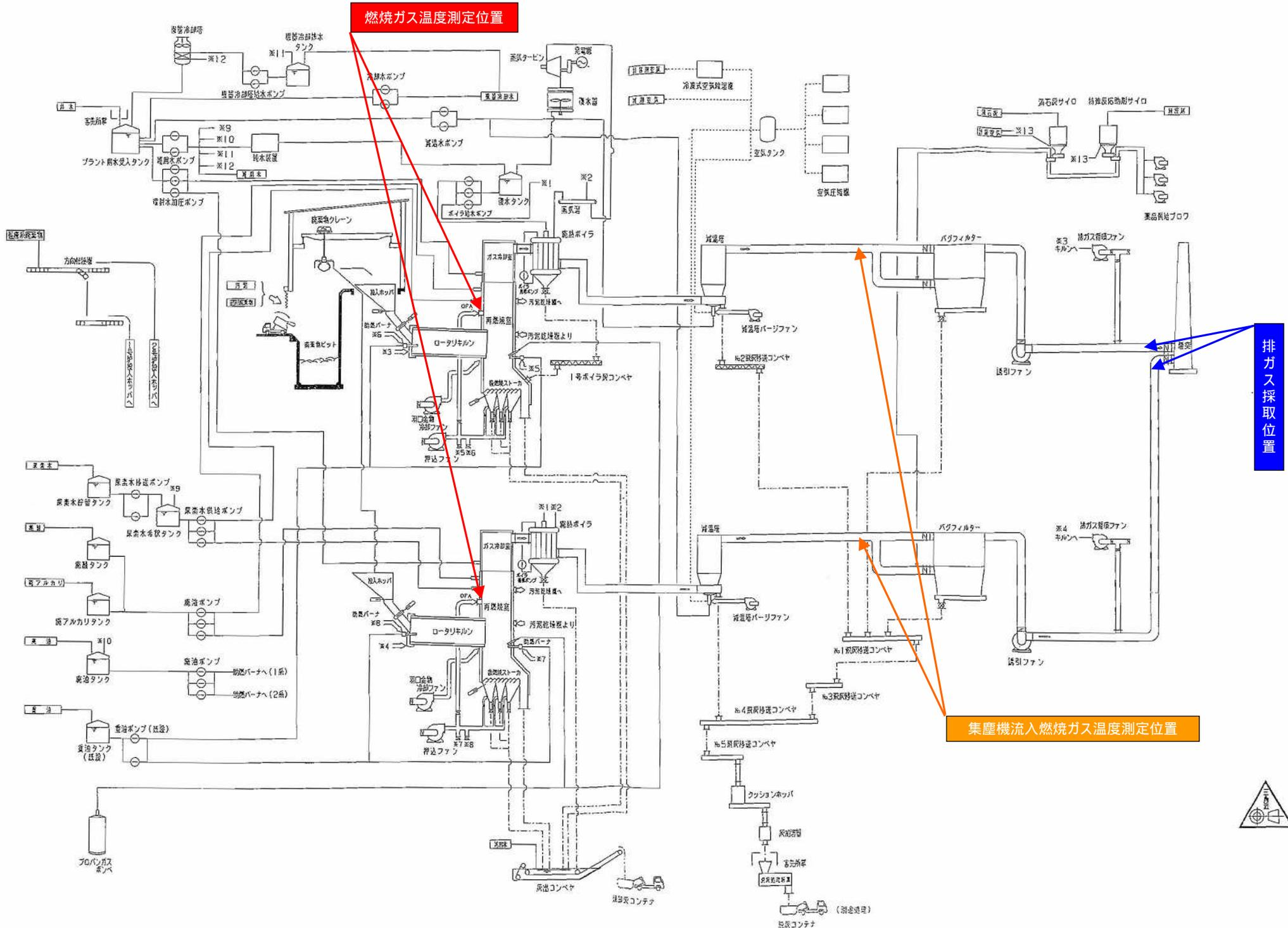
燃焼ガス温度測定位置
